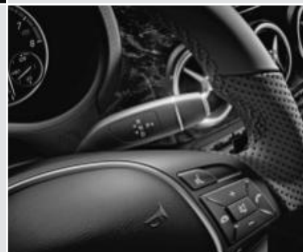
▲ Boîte automatique 7G-DCT avec levier sélecteur DIRECT SELECT
